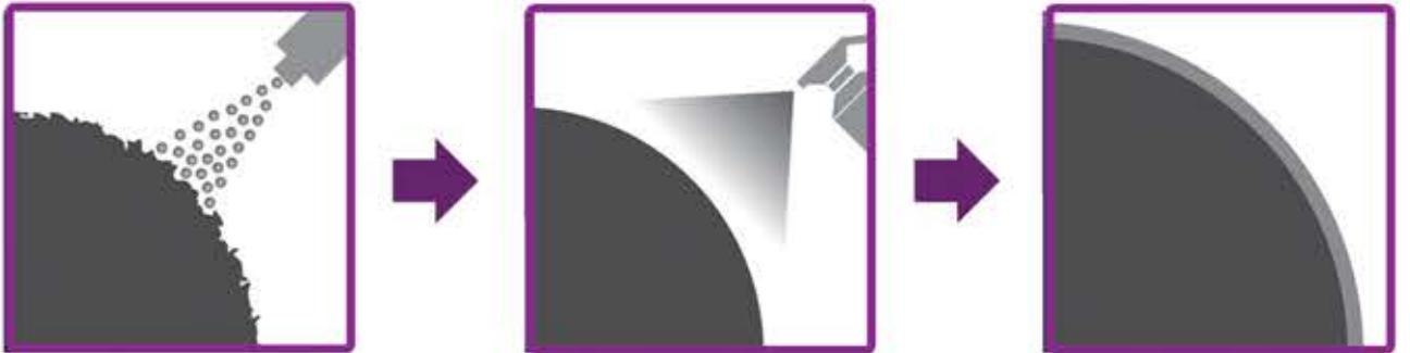
فنر درب سکشنال در زمان باز و بسته کردن درب، مهم ترین نقش را ایفا می کند چرا که فنرها به نگه داشتن وزن کلی درب کمک می کنند. شرکت ورنا برای هر نوع درب سکشنال اعم از پارکینگی و صنعتی، طیفی گسترده ای از فنرها را ارائه می دهد که تمامی این فنرها شات بلاست و کوتینگ شده میباشند. مزایای این فنرها نسبت به فنرها معمولی عبارت اند از:
