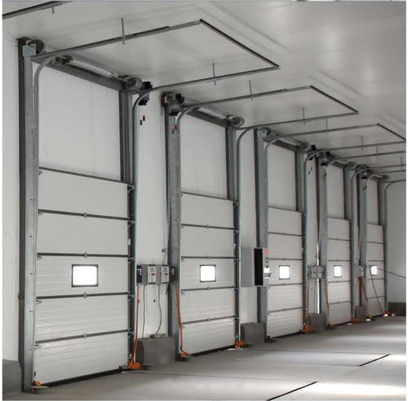
این درب ها همانند نمونه نرمال بلافاصله در زیر سقف قرار نمی گیرند و ابتدا مسیری را به صورت عمودی طی کرده و سپس زیر سقف قرار میگیرند. این مسیر حرکتی باعث می گردد تا در زمان باز شدن کامل درب، تعدادی از پنل ها به صورت عمودی و تعدادی به صورت افقی در زیر سقف قرار گیرند. در این حالت بیشترین فضای بازشو با کمترین اشغال در محیط داخل به شما هدیه داده می شود و هیچ گونه ممانعتی برای فضای داخل سوله بوجود نمی آید.
